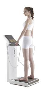
身長測定後に、素足になって測定をします。両手でセンサーを持ち、約1分立っているだけで測定は終了します。
